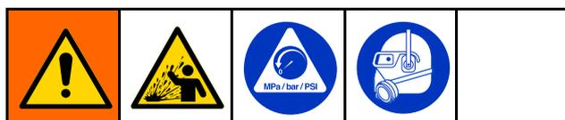
Este equipo seguirá presurizado hasta que se libere manualmente la presión. Para ayudar a evitar lesiones graves por fluido presurizado tales como salpicaduras de fluido, siga el **Procedimiento de descompresión** cuando deje de dispensar y antes de limpiar, revisar o realizar tareas de mantenimiento en el equipo.
